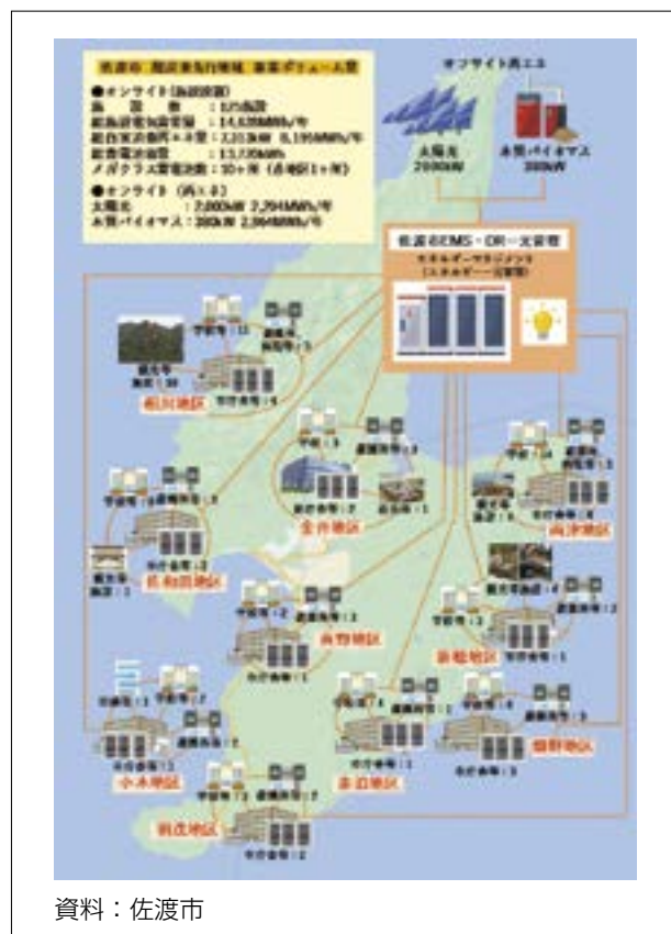
■ 図表1 佐渡市におけるエネルギーマネジメントシステムのイメージ
