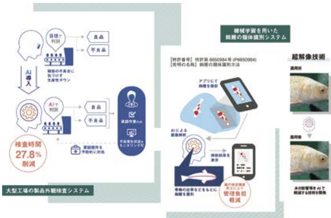
▲AIを活用した画像解析イメージ図。左が大型工場の製品外観検査システム、右が錦鯉の個体識別システム
