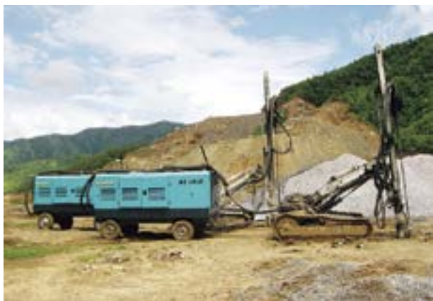
▲中国の鉄鉱石採掘現場で発破孔を穿孔するドリルの動力源として、当社の高圧仕様のエンジンコンプレッサが活躍
