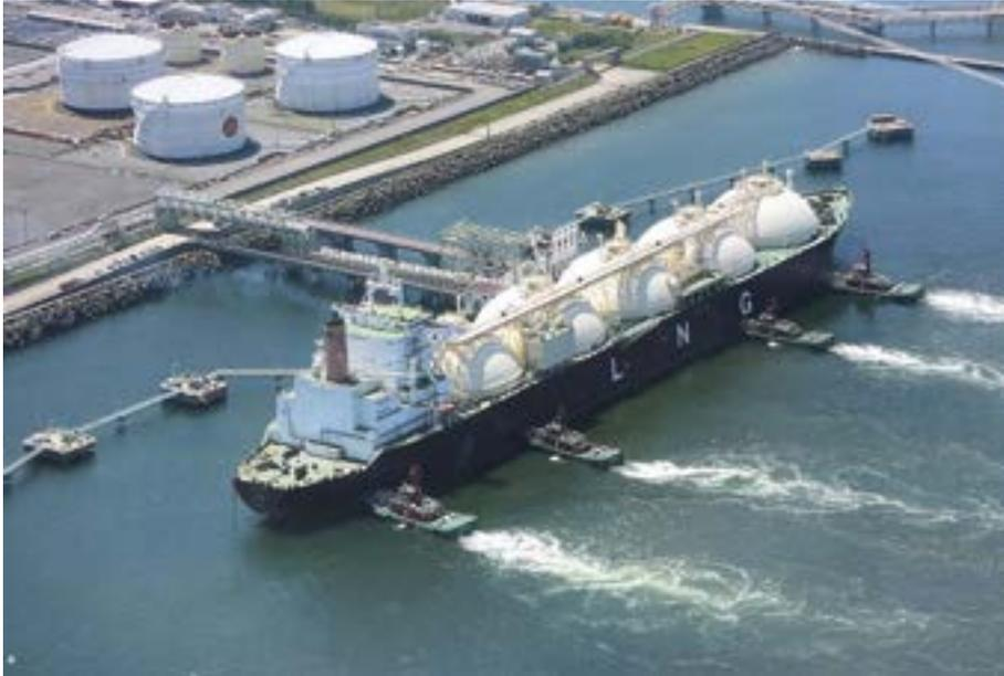
LNGタンカーの着岸作業。水先人の指揮のもと、タグボート4隻が大型タンカーを押ししていく
