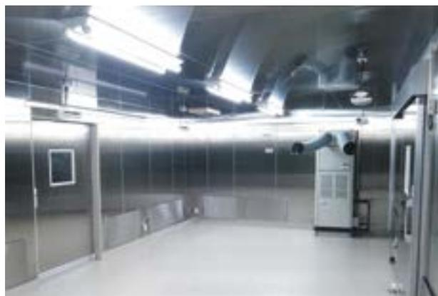
衛生的で温度調節が自由にできる「ステンレスパネル式麹室」
