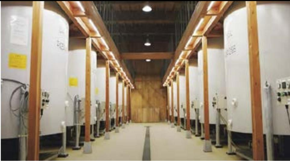
冷却装置を搭載したタンク「サーマルタンク®」。仕込みにも貯蔵にも使用できる
