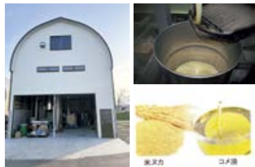
▲米油を製造する専用棟。米糠に圧力と熱をかけて脂分を抽出
