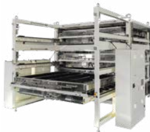
カラーフィルターを加熱・冷却する「HP/CP装置」
