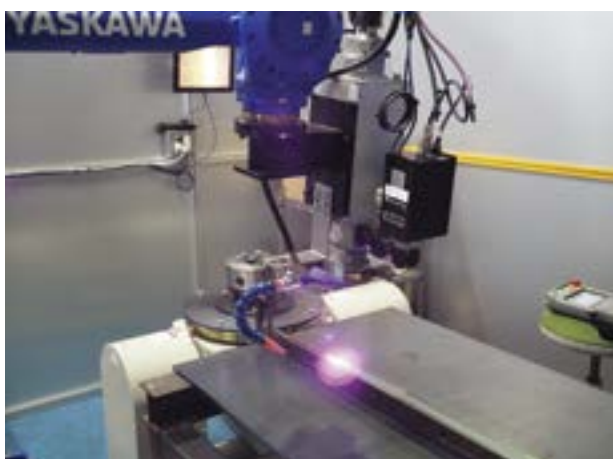
レーザー焼入れ機による作業風景
