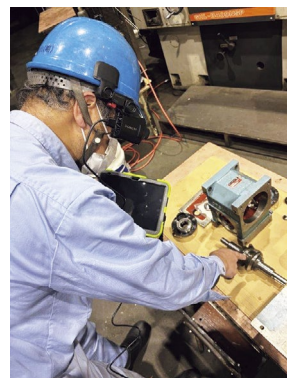
ヘルメットに取り付けたカメラ映像により遠隔地での作業を支援
