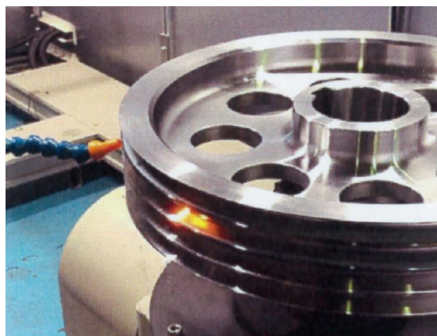
【レーザー焼き入れの様子】
