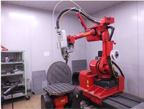
形 式：ファイバーレーザー溶接機 FLW4000 加工能力：4kW メーカー：アマダ 台 数：1
