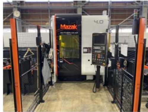
✦ NEW ✦ 形 式：レーザー加工機 FG-220 III 加工能力：4kW 丸材最大加工寸法 220mm 角材最大加工寸法 152mm メーカー：ヤマザキマザック 台 数：1
